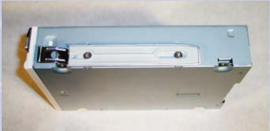
Плъзгаща релса, монтирана за DVD записващо устройство. Използвайте другия отвор, ако искате предната част на устройството да е подравнена с шасито, вместо да се крие зад покриващия панел на устройството.
