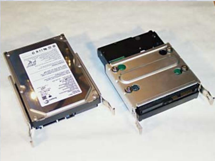
Устройствата Seagate SATA, всяко едно от тях монтирано върху носач на устройство с използване на винтове и втулки, видими на десния изглед.
