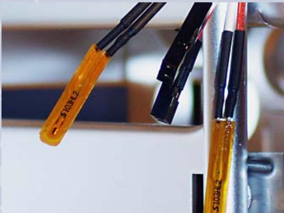
Проби от температурния сензор на предния панел и куплунзи за светодиоди/ превключватели (в средата).
