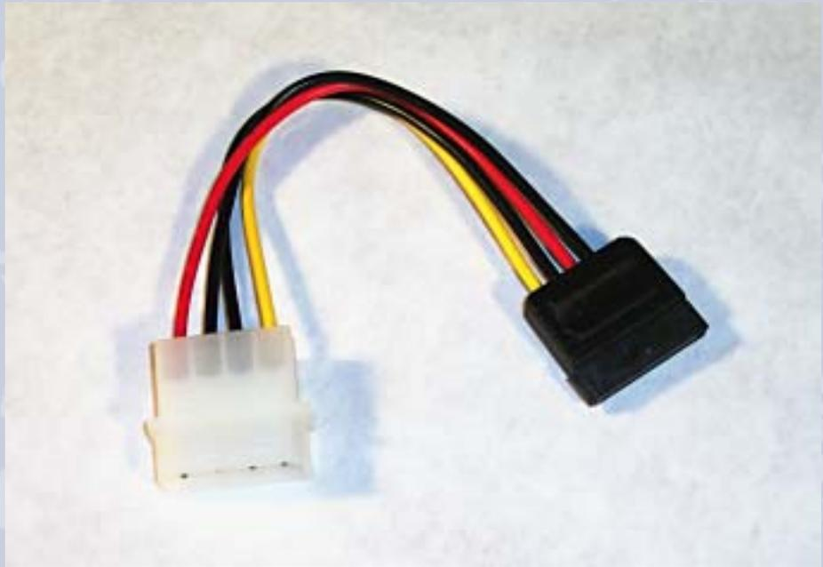
Адаптерът на серийния захранващ кабел АТА трансформира конвенционалните куплунзи на дисковите устройства от захранващия блок в към различната форма и брой на крачета, изисквани от задната част на серийните дискови устройства.
