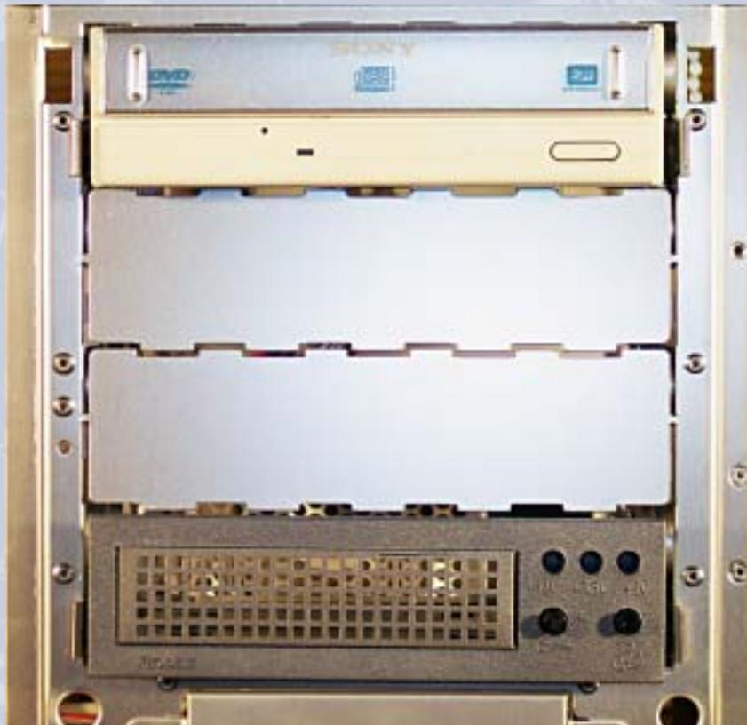
Инсталирахме Sony DRU510a в горната външна 5.25-инчова ниша, а контролиращото устройство на захранващия блок в най-долната. Контролиращото устройство е скрито зад празна покриваща плочка след инсталирането на предния панел на шасито.
